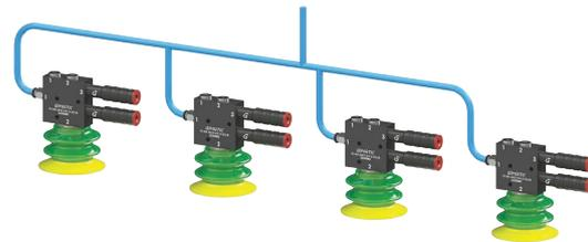
Una instalación descentralizada se diseña de modo que cada ventosa tenga un generador de vacío dedicado, esto significa que todas las ventosas son independientes una de otra, generalmente se utiliza en aplicaciones porosas.
