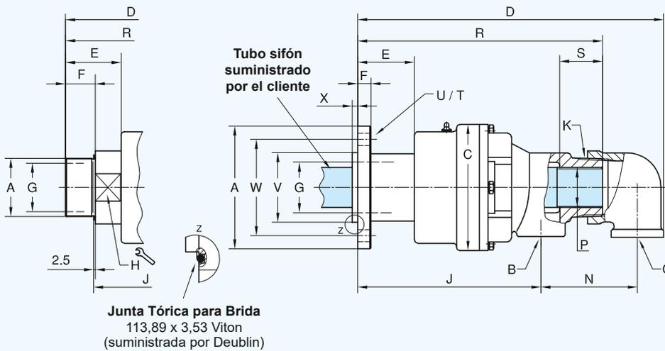
**Diseño de Tubo Sifón Rotativo**
