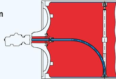
Las juntas rotativas de la Serie H se pueden utilizar conjuntamente con los Sistemas de Sifón Deublin. Los sifones fijos y rotativos se fabrican a medida para adaptarse a las exigencias del cliente. Para más información, ver nuestro catálogo "Juntas Rotativas y Sistemas de Sifón para la Industria del Papel", o contacte con Deublin directamente.
