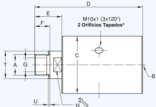
\* Disponga el orificio de aireación abierto hacia abajo, o cambie uno de los tapones de manera adecuada.
