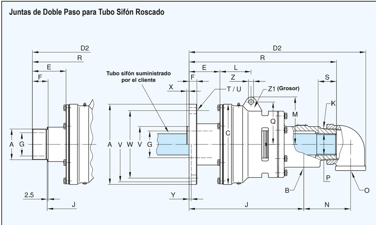
**Juntas de Doble Paso para Tubo Sifón Roscado**
