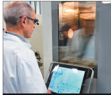
Caja térmica para el ensayo de envejecimiento
