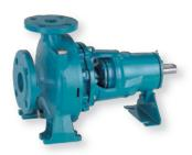
Bombas en ejecución normalizada según EN733, en versión eje libre. Acopladas a motor eléctrico o diésel mediante acoplamiento que permita su reparación y mantenimiento sin que sea preciso desembridarla ni desmontar el motor. Disponen de rodete fabricado en bronce fundido en una sola pieza. Sellado mediante empaquetadura, no siendo posible realizarlo con cierre mecánico.
