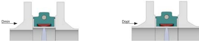
**Dmin** El diámetro interior mínimo requerido para asegurar la operatividad sin fallos. (En este caso la válvula debe estar centrada óptimamente)
